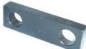
Gabarito para medir o eixo de comando para bombas A e B - 17mm e 20mm
